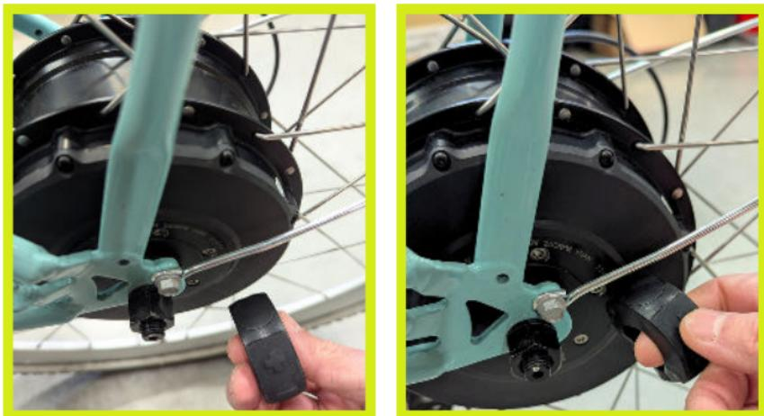
**b) Moteur All-In-One (batterie intégrée)** : la sortie du signal se situe entre le capot moteur et le carter. Déplacez le bouton autour du capot pour trouver la position où le signal est le plus fort.
