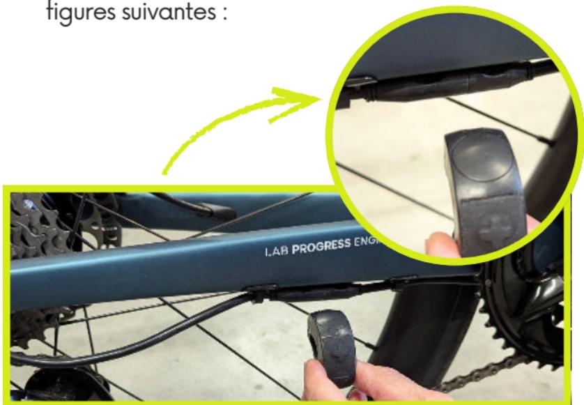
a) **Moteur avec batterie externe** : la sortie du signal se trouve au niveau du connecteur du câble
