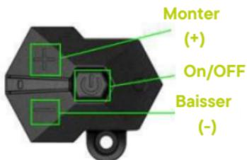
Maintenir le bouton On/OFF pendant 1 seconde permet d'allumer ou d'éteindre l'appareil. Celui-ci peut automatiquement s'éteindre lorsque vous ne l'utilisez pas pendant un certain temps.
