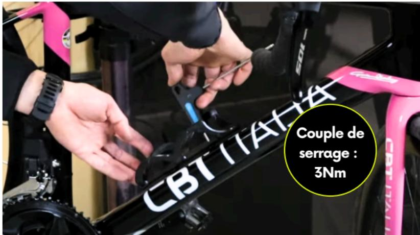
Installez ensuite votre porte-bidon sur le cadre. Il est recommandé de le placer sur le tube diagonal.
