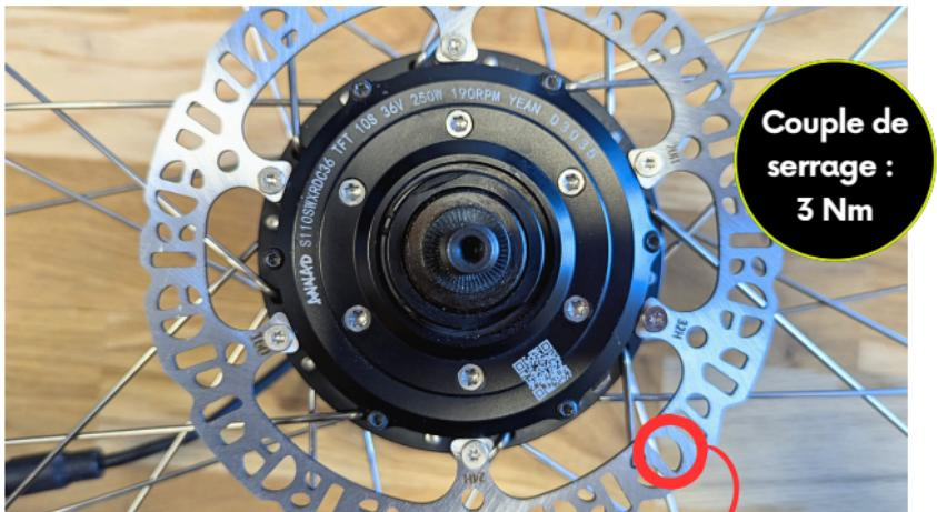
Les demi-lunes (en rouge) doivent être positionnées dans le sens de rotation. Les gravures correspondant au nombre de rayons doivent être face extérieures (visibles lorsque vous montez le disque)
