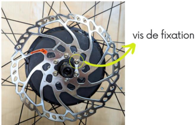
Installez ensuite votre disque dans le sens de rotation de la roue (cette indication est présente sur le disque) et revissez les 6 vis de fixation avec de la colle loctite. Couple de serrage : 3Nm.
