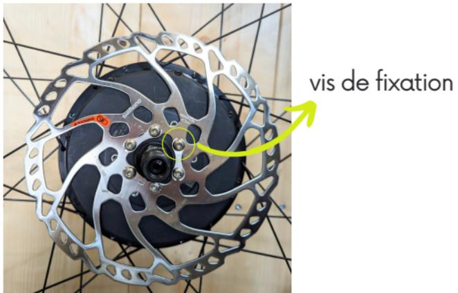
Installez ensuite votre disque (non fourni) dans le sens de rotation de la roue (cette indication est présente sur le disque) et revissez les 6 vis de fixation avec de la colle loctite. Couple de serrage : 3Nm.
