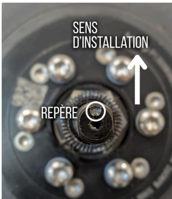
Placez la roue dans son axe. Pour la placer dans le bon sens : veillez à ce que le port de chargement de la batterie intégrée sorte sur le côté droit du vélo.
