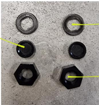
Placez une rondelle + un écrou + un bouchon aimanté du côté droit (côté cassette). L'autre bouchon vous servira en cas de perte du premier.
