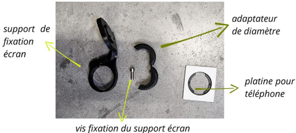
Selon le diamètre de votre cintre, vous pouvez utiliser l'adaptateur de diamètre avant d'installer le support de fixation. Vissez ensuite le support de fixation avec la vis fournie.
