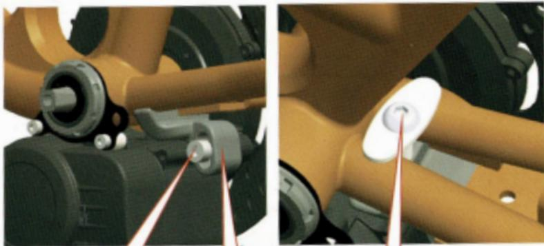
1) Placez le bloc de serrage et pré-serrez par le côté
