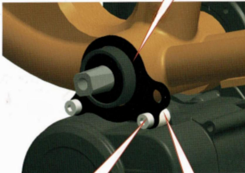
3) Insérez une vis dans chaque bague et placez une rondelle entre la plaque et la tête de vis
