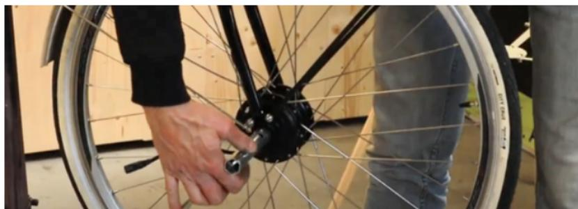
Finaliser le serrage de la roue grâce aux écrous fournis et à l'aide de la clé démonte-roue qui se trouve dans le kit. Couple de serrage : 25Nm
