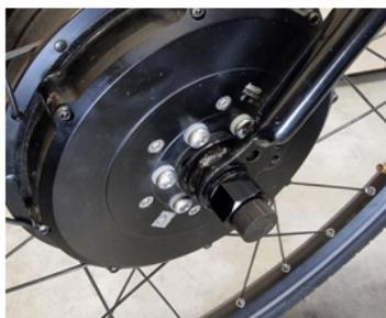
L'embout aimanté permet d'activer le moteur, si vous le retirez, celui-ci sera mis hors tension.
